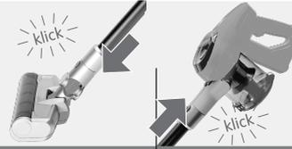
Rohr mit Boddüse aufstecken
